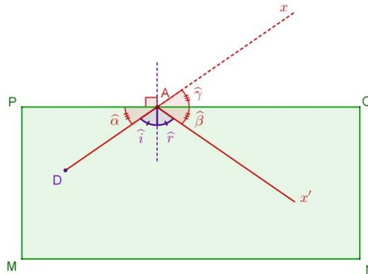
En effet, suivant les lois de la réflexion, les angles  $\hat{\alpha}$  et  $\hat{\beta}$ , complémentaires respectifs des angles de même mesure  $\hat{i}$  et  $\hat{r}$ , sont encore de même mesure, tandis que les angles  $\hat{\beta}$  et  $\hat{\gamma}$  sont de même mesure, par symétrie.
