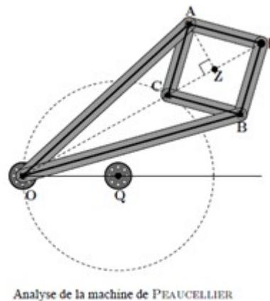
Par construction,  $C$  décrit un cercle de diamètre  $[OR]$  (où  $R$  est le symétrique de  $O$  par rapport à  $Q$ ). Il reste à vérifier que  $OC \times OP$  est constant lors du mouvement du système articulé.
